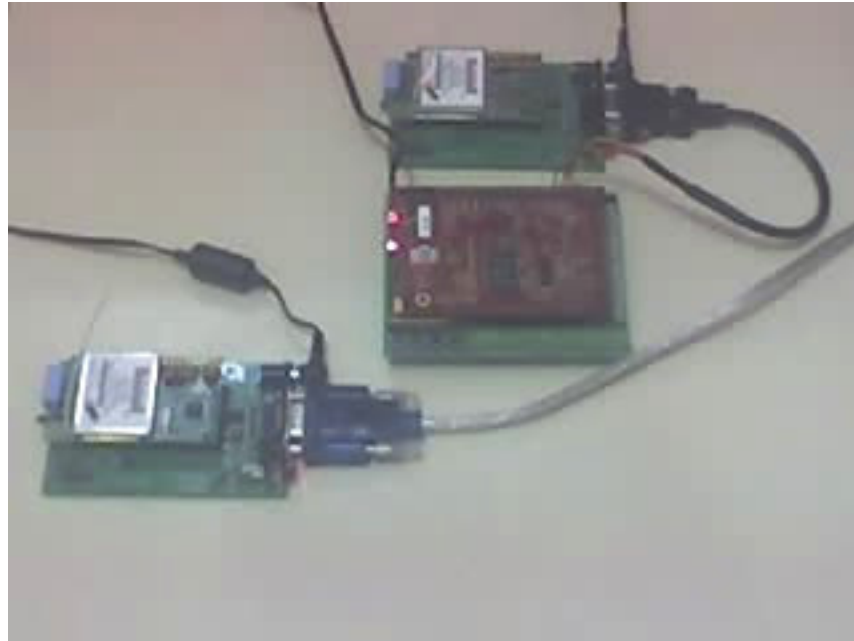
Figura 65: Montagem completa para comunicação entre o PC e a LP3500 de forma wireless
