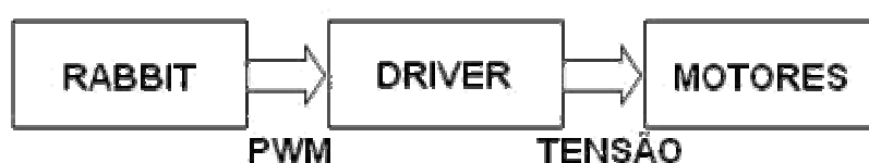
Figura 112: Função do driver e sinais de entrada e saída
