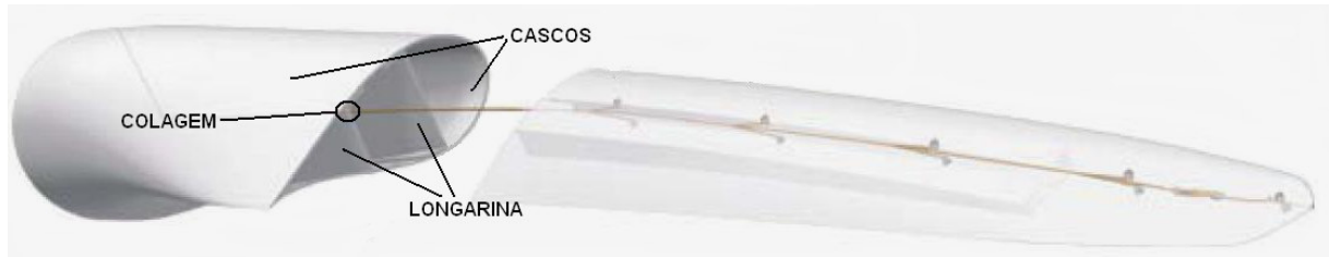
Figura 3: Partes constituintes de uma pá
